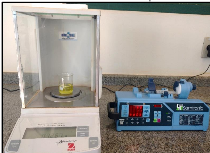
Figura 7. Equipamento utilizado para determinação da tensão superficial das caldas de aplicação da mistura comercial e mistura em tanque de diuron e sulfentrazone.
