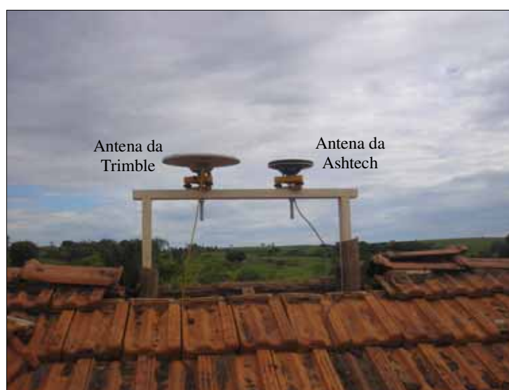
Figura 19 – Disposição das antenas GPS no experimento realizado no município de Parapuã
