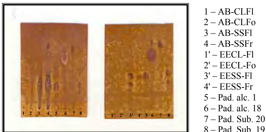
Figura 29. Cromatoplasas comparando o perfil alcaloídico da extração ácido/base (1, 2, 3, 4), e das matrizes tratadas conforme item 3.6 (1', 2', 3', 4'), com os padrões isolados de S. spectabilis ( \text{SiO}_2 GF 254 ; \text{CHCl}_3 :MeOH:NH 4 OH; 9:1:0,25; ICIpt).
