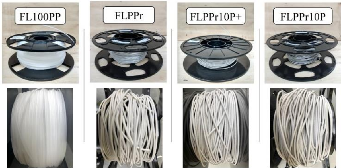
Figura 27 – Filamentos comercial (FL100PP) e sustentáveis (FLPPr, FLPPr10P+ e FLPPr10P) fabricados por extrusão condicionados em bobinas para impressão 3D.
