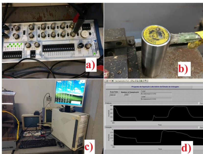
Figura 21 - Equipamentos para aquisição de dados de Potência e Vibração – (a) Módulo de Canais; (b) Sensor Vibro Control; (c) Computador utilizado para armazenamento; (d) Interface do software LabView
