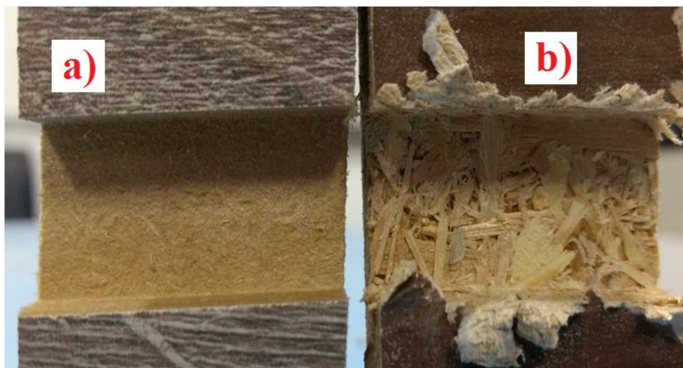
Figura 58 - Comparação do acabamento superficial a) MDF; b) MDP
