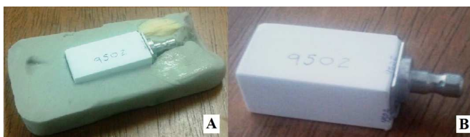
Figura 14 - Preparação do bloco para a usinagem CAD/CAM. (A) molde e colagem do pino, (B) bloco pronto para a usinagem.
