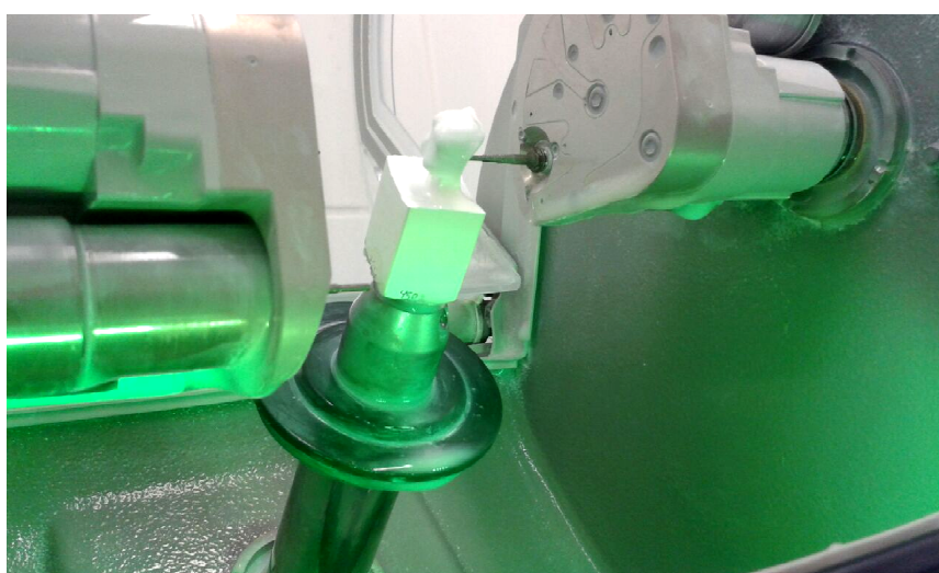
Figura 27 - Confecção de coping para implante odontológico, por CAD/CAM.
