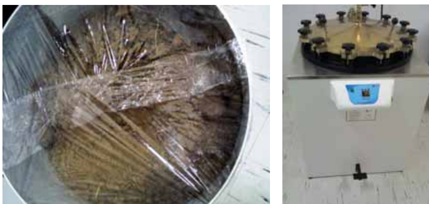
Figura 6 - Acondicionamento componentes do substrato (solo e turfa) em panela de alumínio para o processo de autoclavagem à temperatura de 121°C durante 50 minutos.
