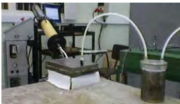
Figura 3 – Conexão da injeção no molde, da saída do molde para o trap e do trap para a bomba de vácuo.
