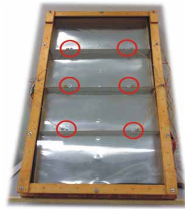
Figura 17: Vista superior, com destaque dos sensores fixados no vidro.
