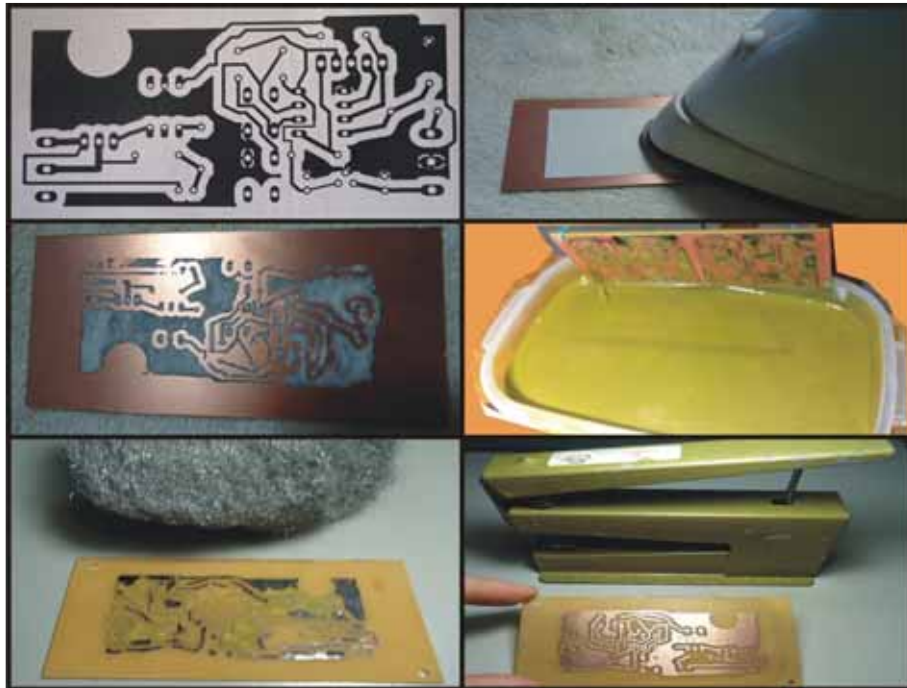
Figura 31: Passos da confecção da placa de circuito eletrônico.
