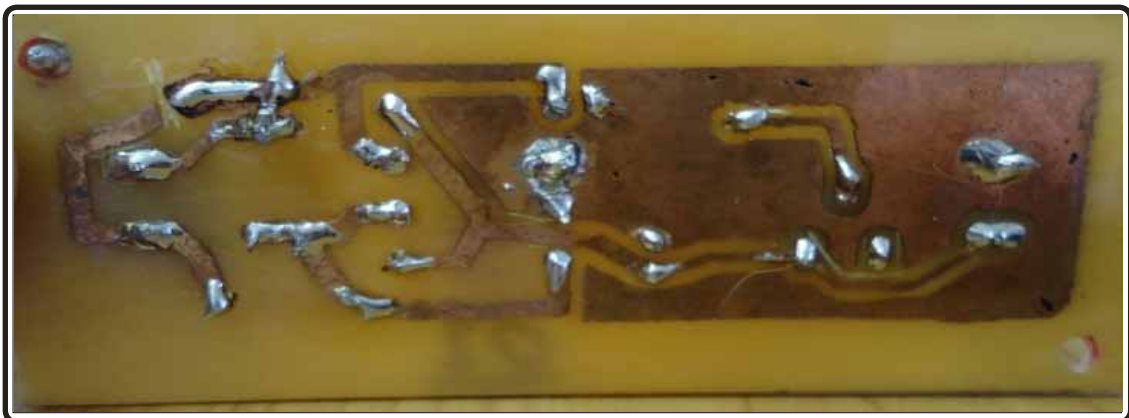
Figura 40: Parte inferior da placa de condicionamento da voltagem.
