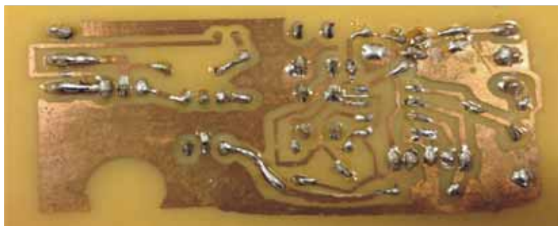
Figura 33: Parte inferior da placa de controle de temperatura com as trilhas.
