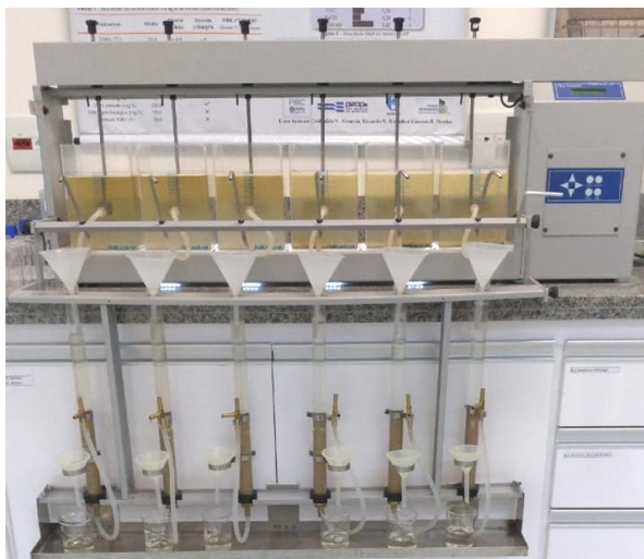
Figura 9 – Jar test utilizado nos ensaios da marca PoliControl modelo FlocControl III de 6 jarros com filtro de areia acoplado.
