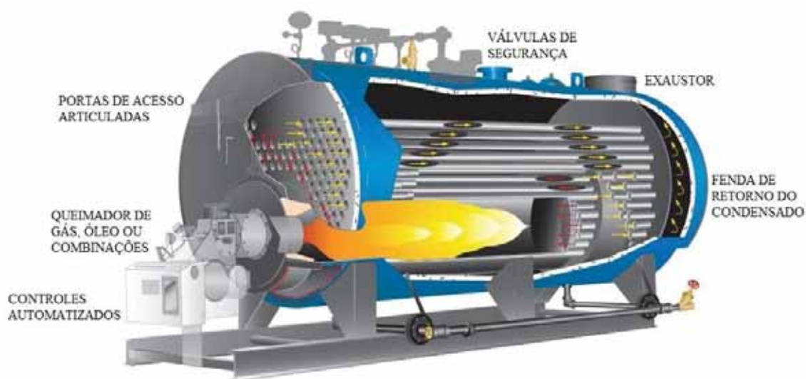
Figura 4: Caldeira flamotubular [2].
