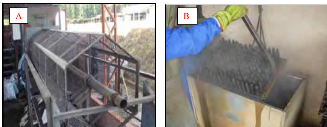
Figura 03. A. Equipamento utilizado para retirada de restos vegetais e substrato dos tubetes. B. Equipamento utilizado para lavagem de tubetes a 80° C.
