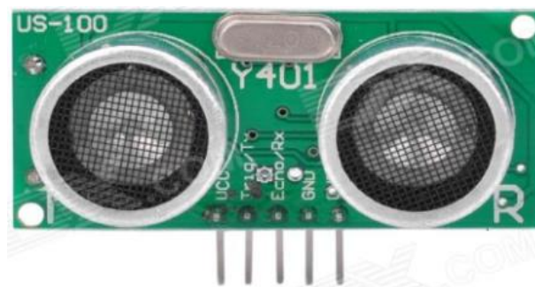
Figura 5. Transdutor eletroestático, emissor L (esquerda) e um receptor R (direita).
