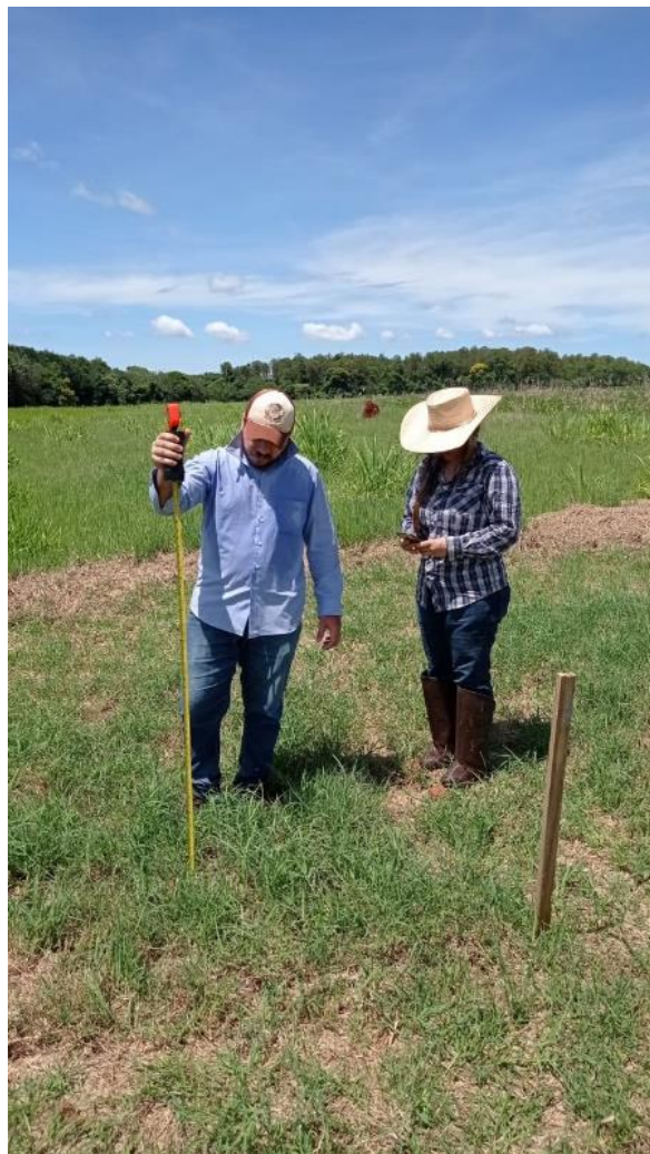
Figura 6. Medidas da altura do dossel com auxílio do sensor de ultrassom portátil.
