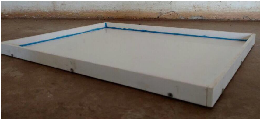
Figura 25 – Forma 400 x 300 x 15 mm de PVC utilizada para confeccionar os corpos de prova de resistência à flexão.
