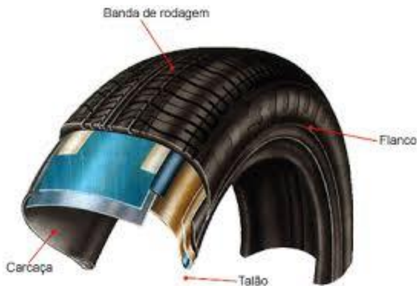
Figura 5 – Partes componentes do pneu.
