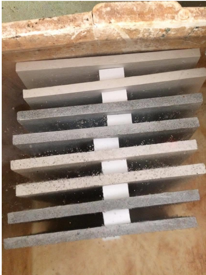
Figura 24 – Corpos de prova submersos em água para ensaio de absorção.
