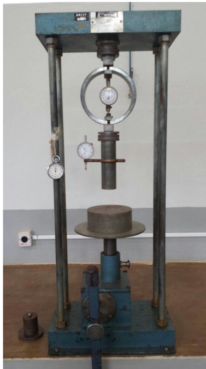
Figura 26 – Prensa CBR para ensaios de resistência à flexão.
