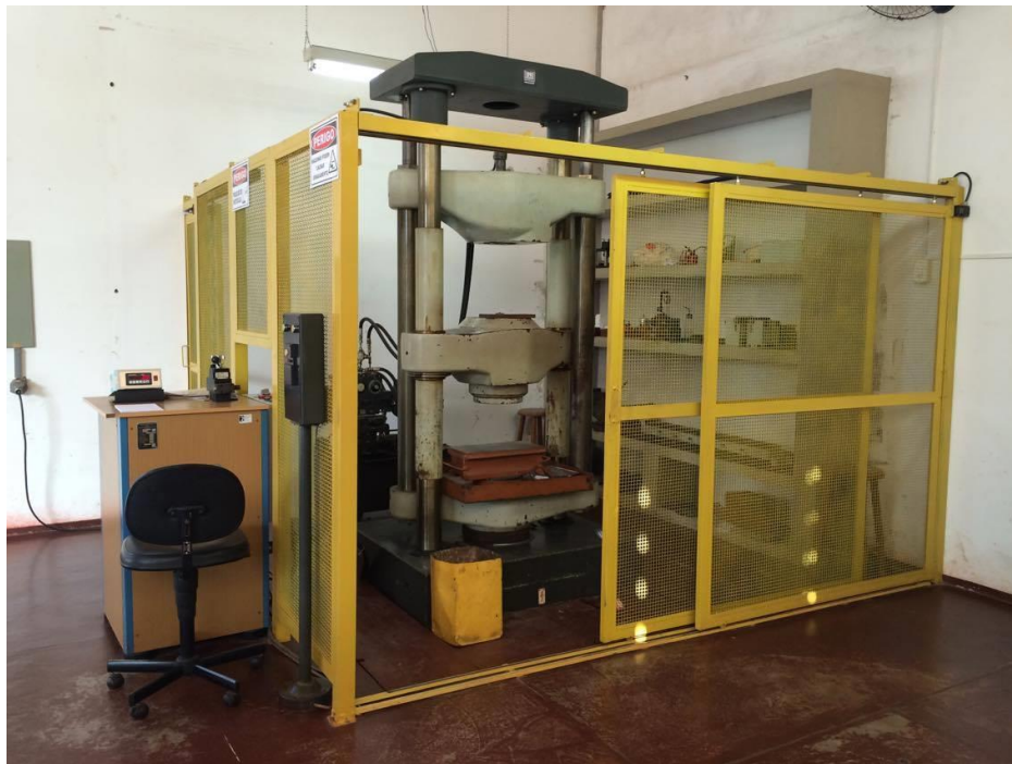
Figura 32 – Prensa universal para ensaios de resistência à compressão.
