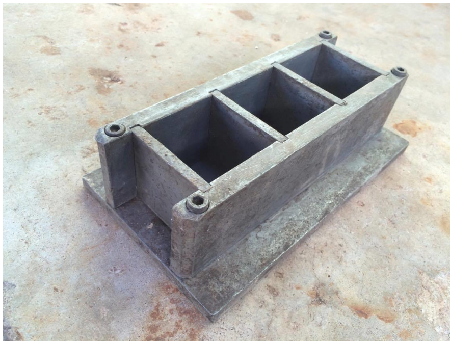
Figura 31 – Forma metálica para confecção dos corpos de prova de resistência à compressão.
