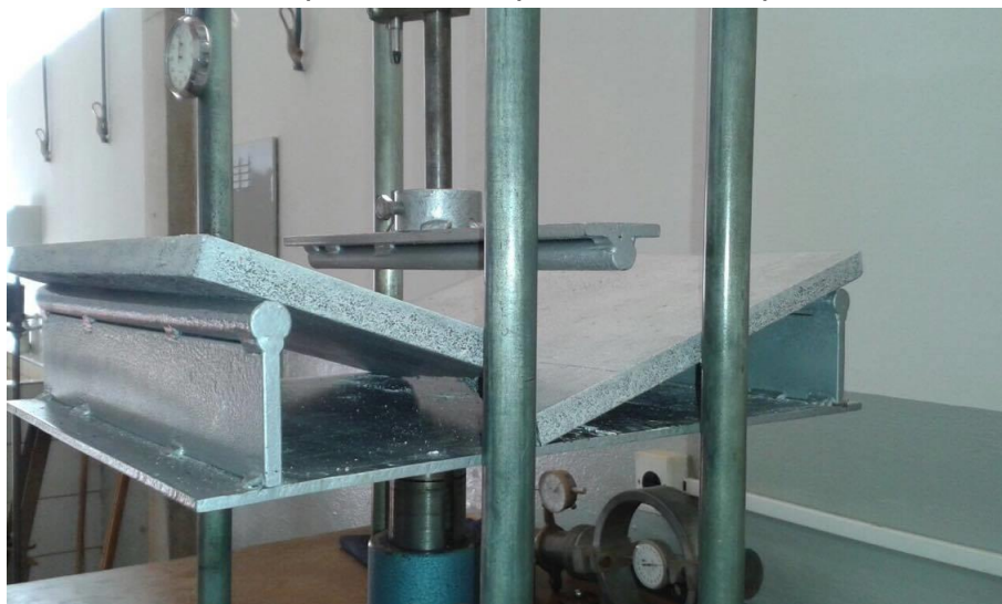
Figura 46 – Placa do compósito 1, completamente rompida ao final do ensaio.
