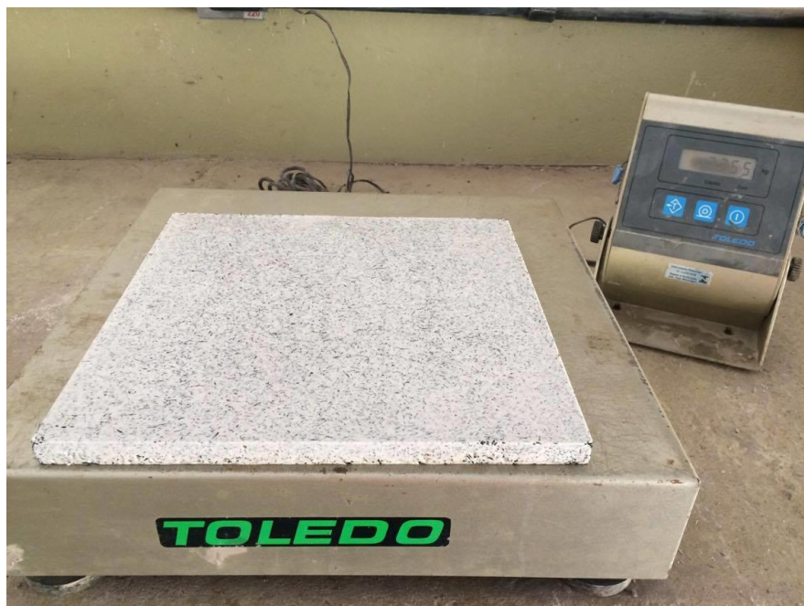
Figura 30 – Corpo de prova sendo pesado no ensaio de densidade superficial de massa.
