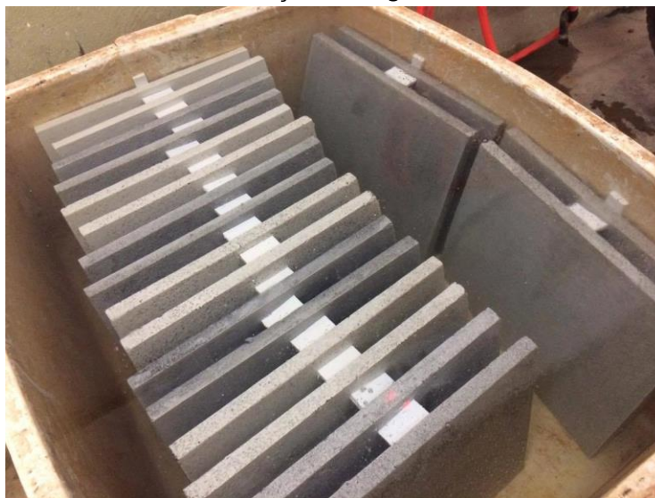
Figura 43 – Ensaio de absorção de água em todos os compósitos.
