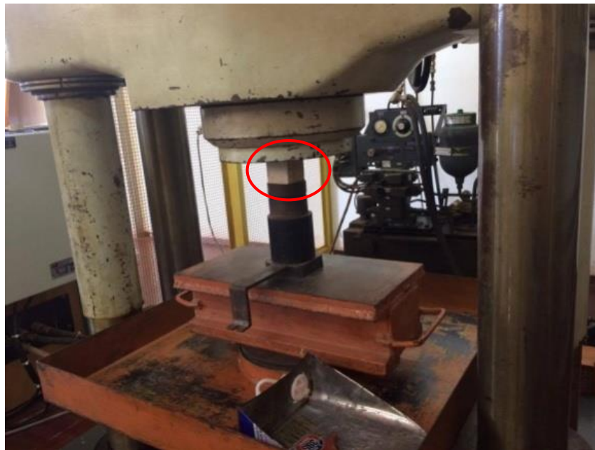
Figura 33 – Corpo de prova cúbico sendo submetido ao ensaio de resistência à compressão.
