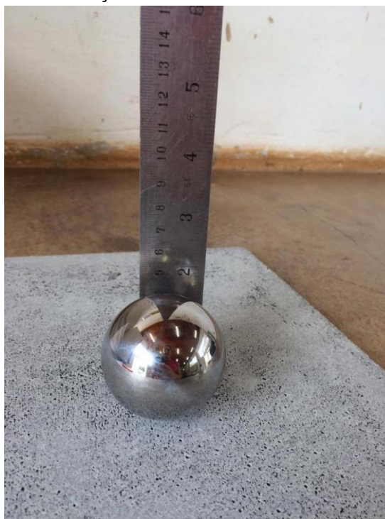
Figura 28 – Esfera de aço utilizada no ensaio de dureza superficial.
