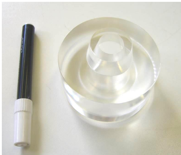
Figura 21 – Modelo tronco-cônico utilizado no ensaio de consistência.
