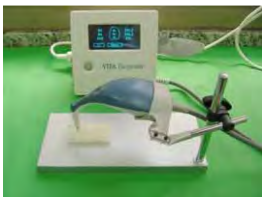
FIGURA 13 – Suporte confeccionado para apoio da ponta medidora do Easyshade
