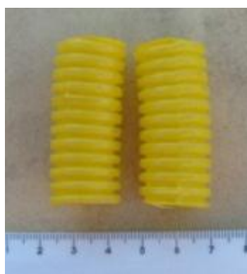
Figura 6. Fotos dos anéis de eletroduto corrugado (conduíte) utilizados como meio suporte nos reatores anaeróbios horizontais de leito fixo e no filtro biológico percolador nos ensaios 1, 2 e 3.
