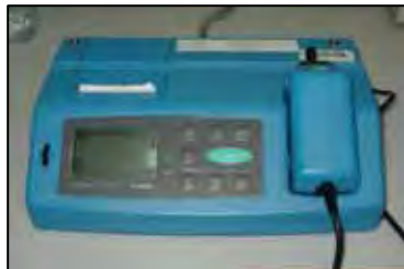
Rugosímetro Hommel Tester T 1000 (Hommelwerke, GmbH, Alte Tuttinger Strebe 20. D-7730 VS- Schwenningen.),
