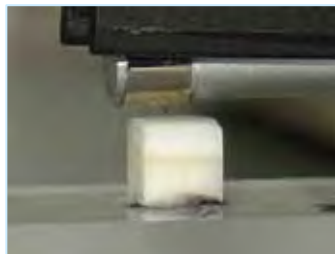
Rugosímetro Hommel Tester T 1000 (Hommelwerke, GmbH, Alte Tuttinger Strebe 20. D-7730 VS- Schwenningen.),
