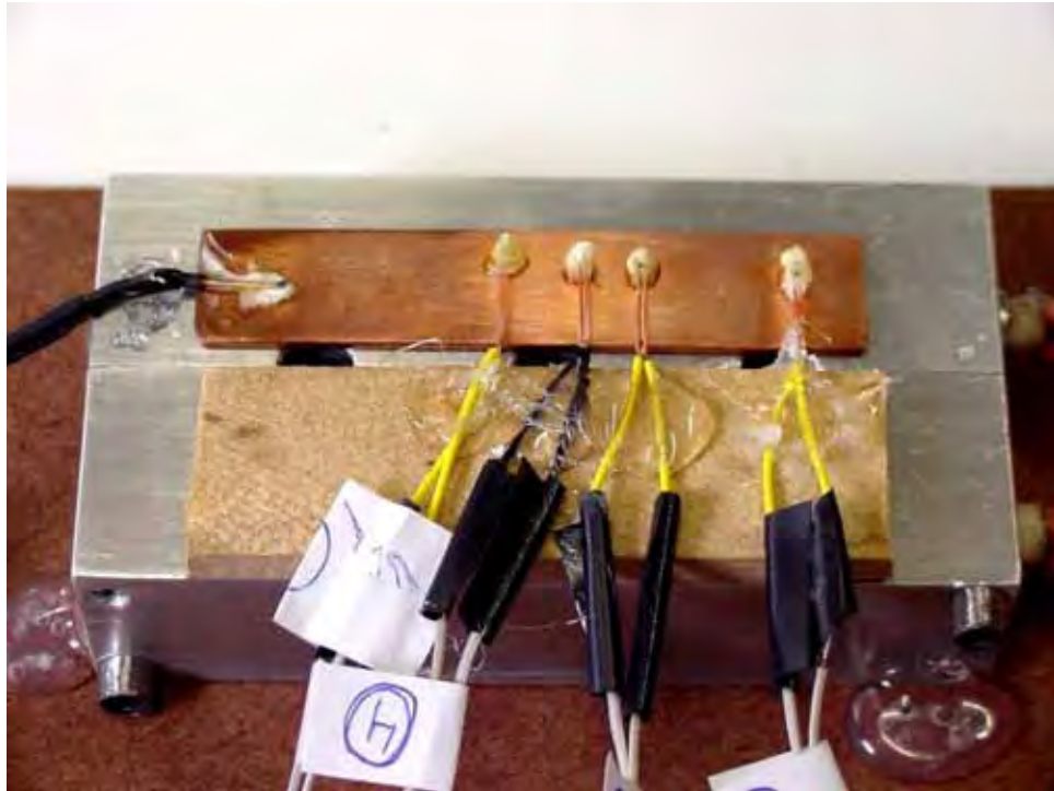
FIGURA 13- Detalhe dos fragmentos colados sobre a placa de cobre com os termistors acoplados na porção superior de cada fragmento.
