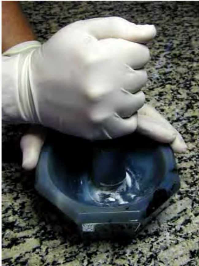
FIGURA 3- Desaglomeração do tecido dental (esmalte ou dentina).
