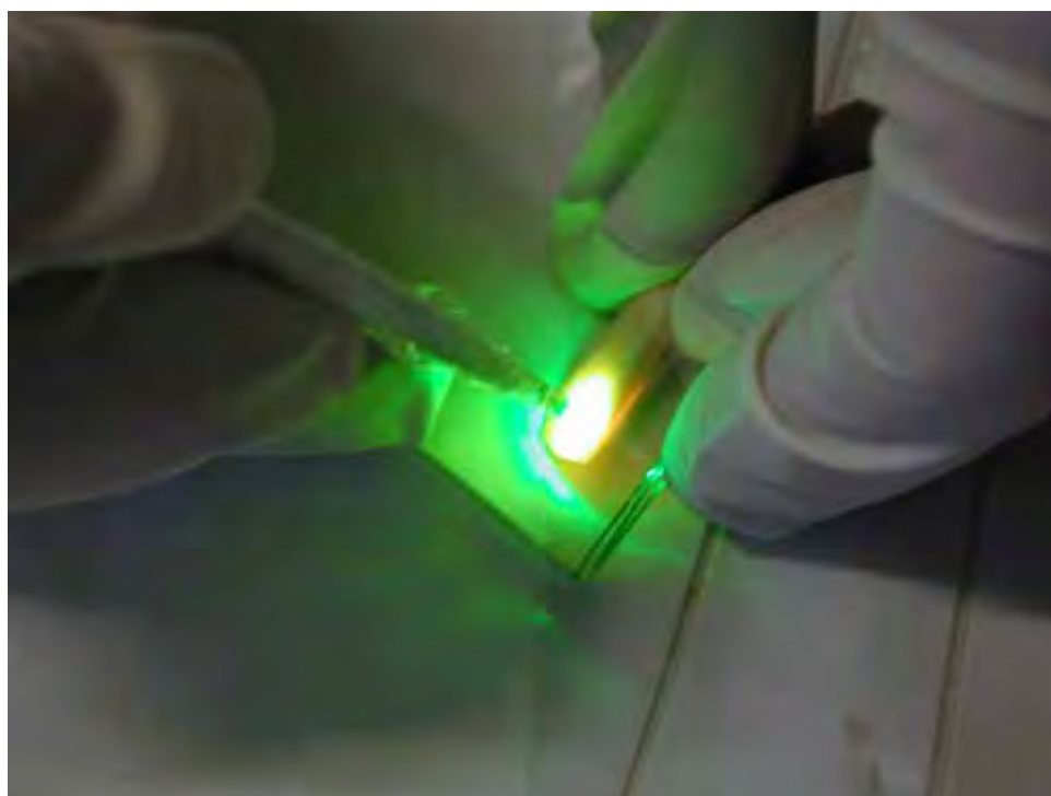
FIGURA 20- Espectroscopia de fluorescência do Nd:YAG dobrado.
