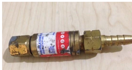
Figura 15 - Válvulas de retenção
