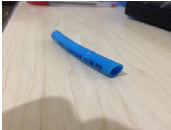
Figura 14 - Mangueira utilizada no gerador
