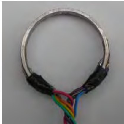
Figura 19 – Transdutor de força do tipo anel circular de alumínio com os extensômetros colados.
