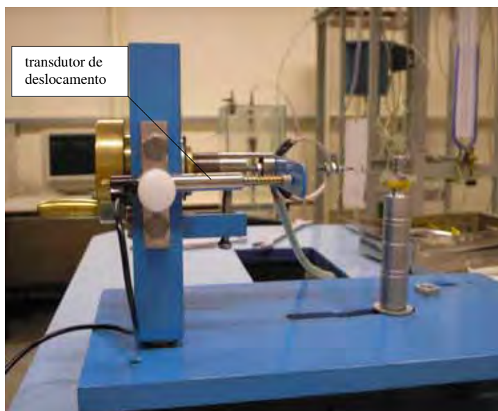
Figura 27 – Ensaio com transdutor de deslocamento acoplado ao dispositivo.
