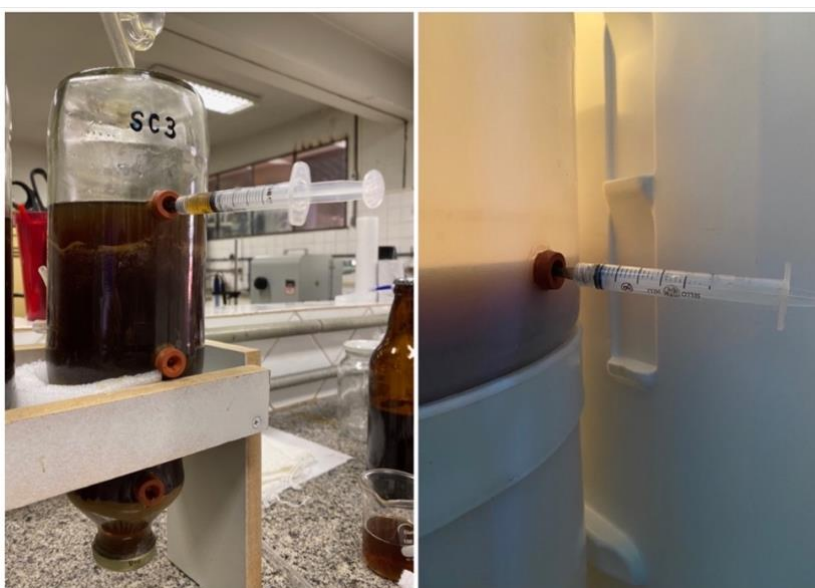
Figura 16: Método de coleta das amostras nas diferentes alturas dos reatores.
