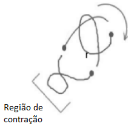
Figura 9: Gráfico de órbita de um mecanismo de falha do tipo roçamento.
