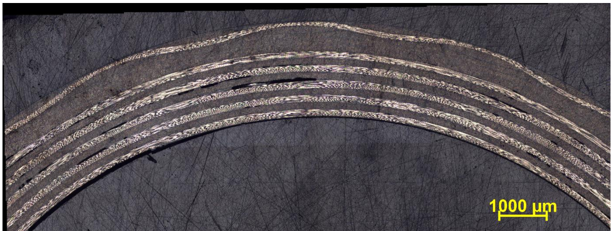
Figura 24: Microscopia da seção transversal do eixo de compósito.
