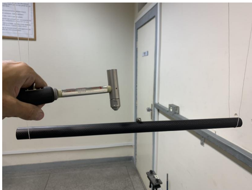
Figura 14: Montagem de ensaio para análise de frequências naturais e amortecimento
