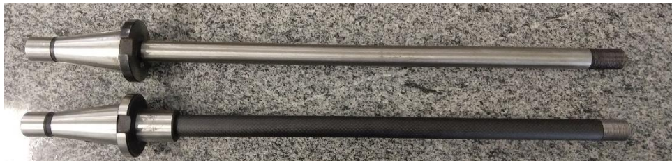
Figura 17: Eixo de compósito preparado para fixação na fresadora após colagem (em baixo).
