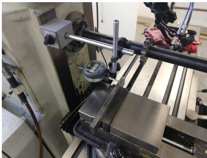
Figura 18: Alinhamento da morsa de fixação com o uso de relógio comparador digital.
