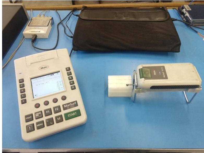
Figura 23: Medição de rugosidade após usinagem das peças.
