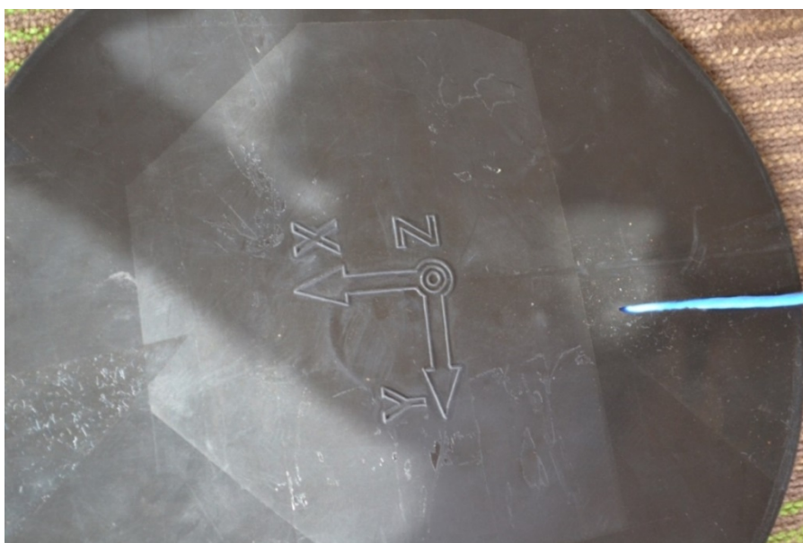
Figura 12: Detalhe da orientação dos três eixos no seat pad SEN027-CBL.
