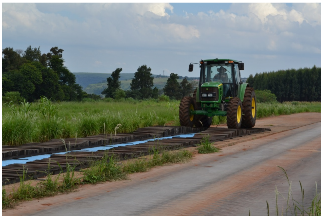
Figura 13: Deslocamento do trator ao longo da pista de vibração.
