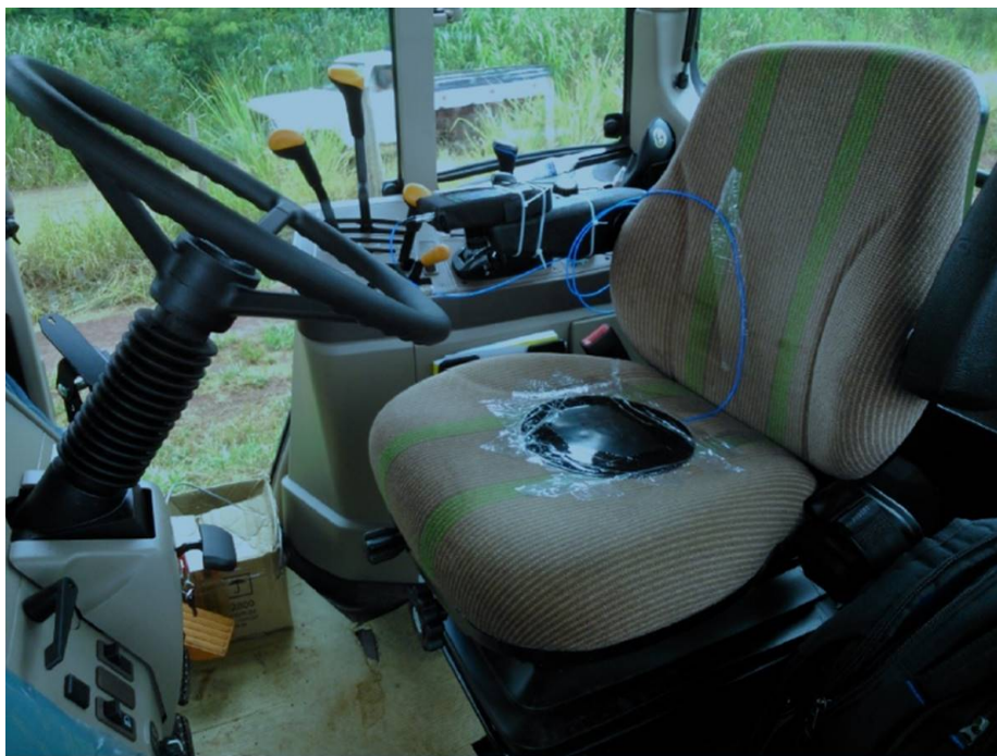
Figura 11: Fixação do transdutor SEN027-CBL no assento do trator seguindo recomendação da NHO 09.
