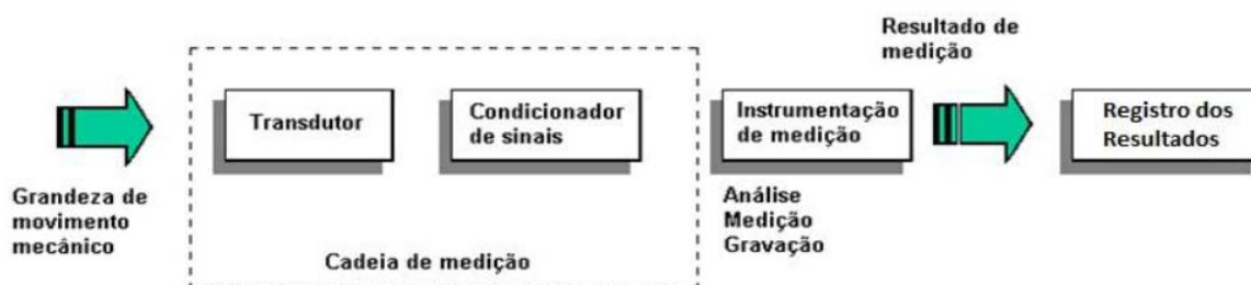
Figura 3: Esquema básico de sistema de medição de vibrações. Fonte: Adaptado de Ximenez, (2006).
