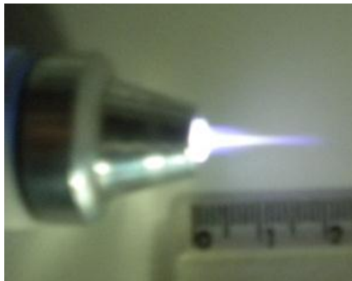
Figura 3: Imagem da tocha de plasma em pressão atmosférica do equipamento desenvolvido neste trabalho.
