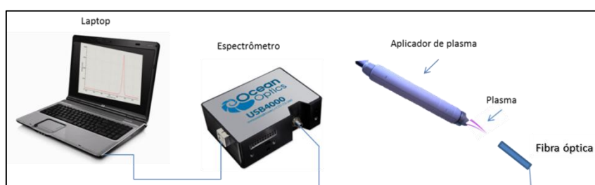
Figura 15: Esquema da montagem usada para caracterização dos plasmas por espectroscopia de emissão óptica
