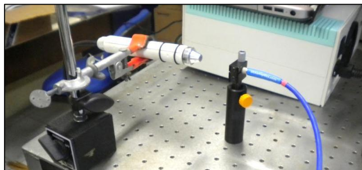
Figura 16: Fotografia mostrando o posicionamento do aplicador de plasma (cilindro cinza à esquerda) próximo à fibra óptica (em azul) para realização da espectroscopia de emissão óptica dos plasmas.
