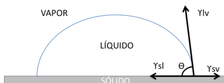
Figura 17: Definição do ângulo de contato formado por uma gota depositada sobre uma superfície sólida. Onde \gamma_{sv} , \gamma_{sl} e \gamma_{lv} são as tensões nas interfaces sólido-vapor, sólido-líquido e líquido-vapor, respectivamente.
