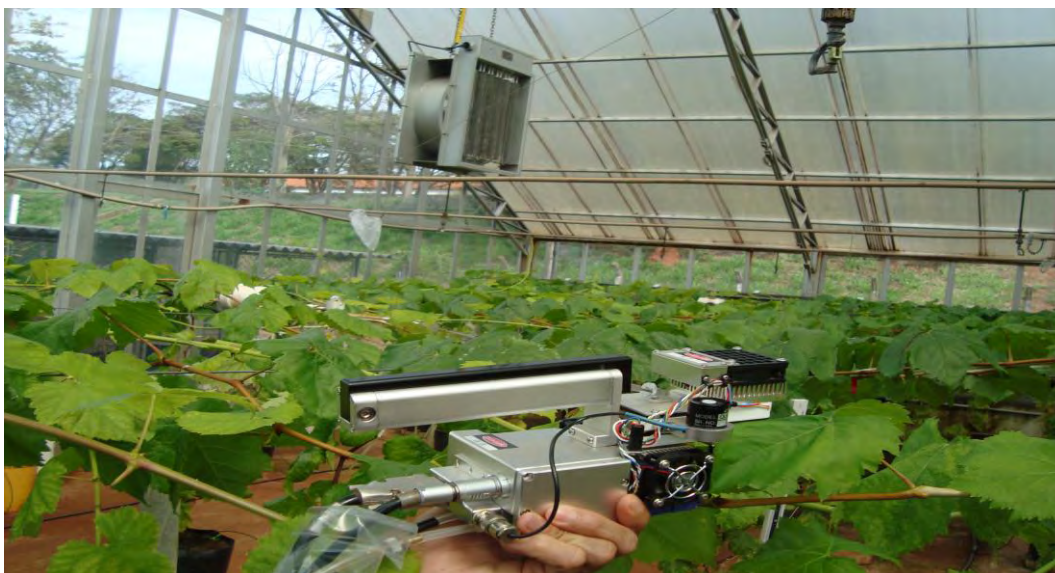
Figura 15. Analisador portátil infravermelho de CO 2 (IRGA), modelo LI-6400 da Li-Cor, utilizado na avaliação de trocas gasosas. FCA/UNESP, Botucatu-SP, 2009.
