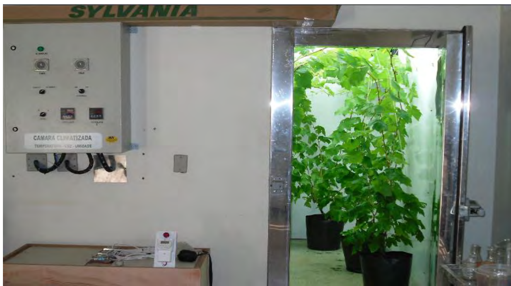
Figura 10. Vista do acesso à câmara climatizada, com o painel de controle na parte externa e forma de distribuição das plantas na parte interna. FCA/UNESP, Botucatu-SP, 2009.
