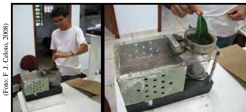
Figura 4. Máquina de varredura de folhas, utilizada para coletar ácaros presentes nas folhas. Ilha Solteira/2008.
