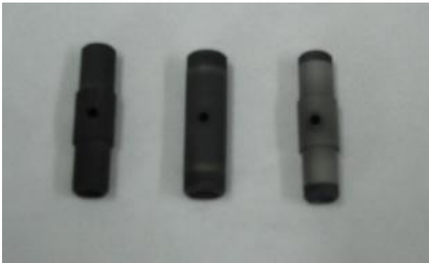
Figura 14. Modelos de Forno de Grafite (nas laterais: tubos de grafite pirolíticos e ao centro: tubo de grafite com plataforma integrada). Foto SALEH, M. A. D.
