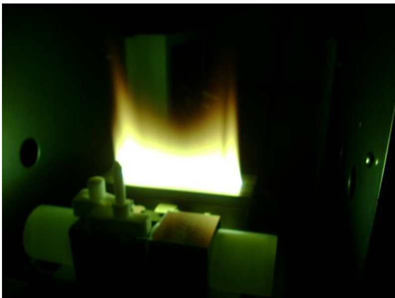
Figura 10. Chama do Espectrômetro de Absorção Atômica. (Foto SALEH, M. A. D.)
