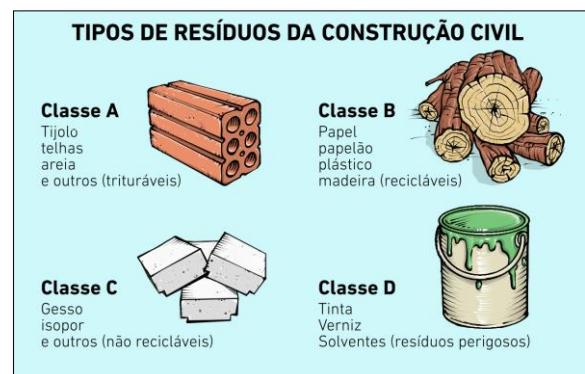
Figura 3. Classes de resíduos da construção civil. (Ilustração: Elias Silveira)
