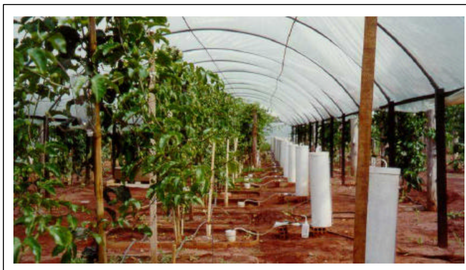
Figura 2-Vista panorâmica do conjunto lisimétrico utilizado para a medida da evapotranspiração da cultura.
