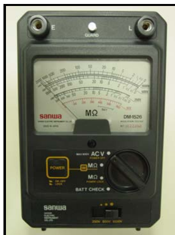
Figura 4.5 – Megôhmetro utilizado para testes de isolamento.
