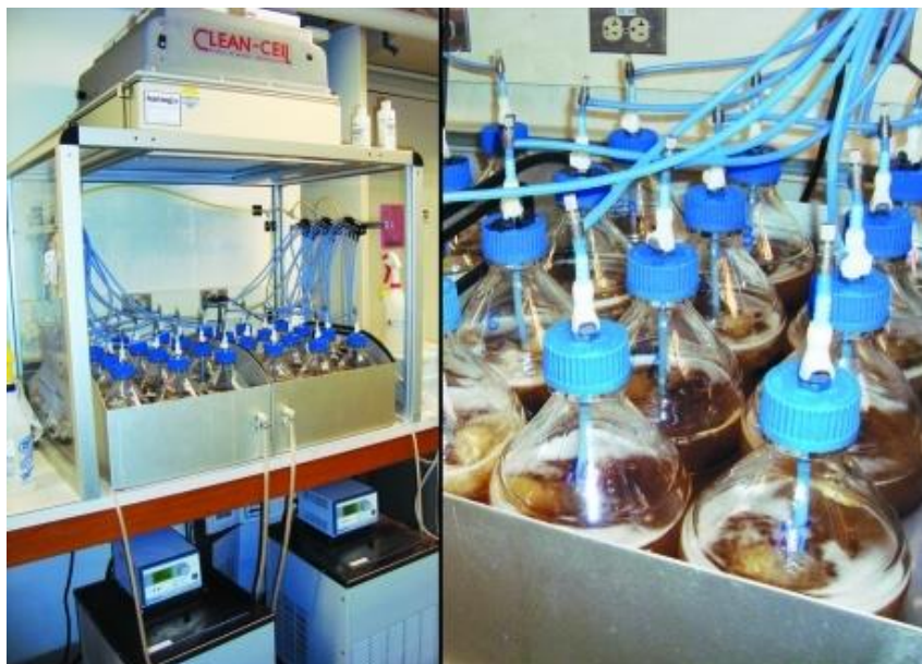
Figura 9. O biorreator LEX cultiva até 24 culturas individuais de 2 L. Seu design geral apresenta um gabinete com linhas de aeração removíveis contendo controles personalizáveis, exaustor de ar acoplados à filtros HEPA, dois circuladores de água com regulação eficiente das condições de temperatura por banho-maria e componentes totalmente esterilizáveis.
