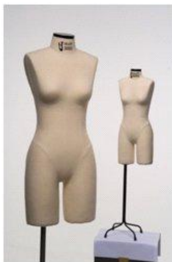
Figura 8 : Manequins de moulage em escala natural e em escala 1:2
