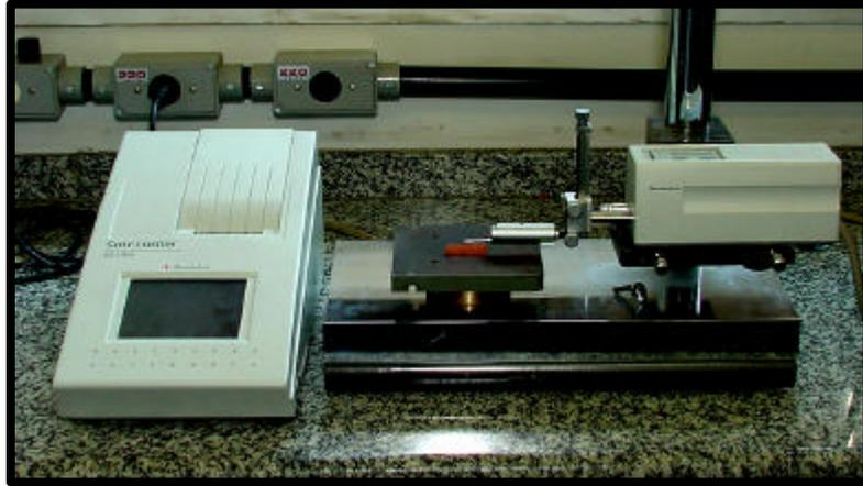
FIGURA 15 – Rugosímetro Surf-Corder SE 1700
