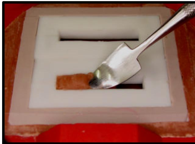
FIGURA 7: Preenchimento das matrizes com material Molloplast-B
