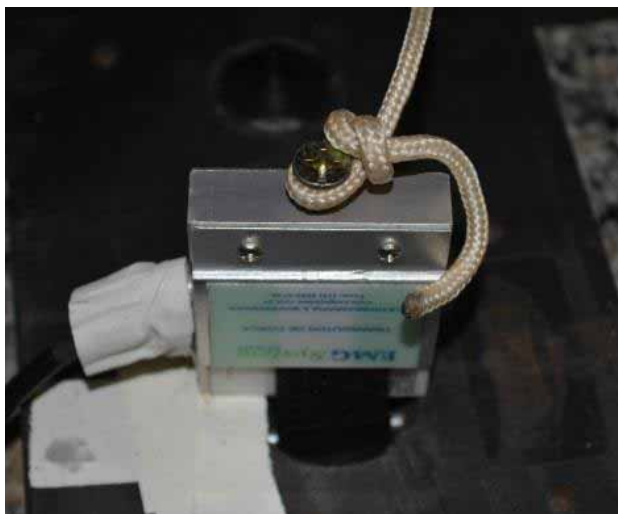
Figura 9: Hastes flexíveis presas no parafuso central da célula de carga
