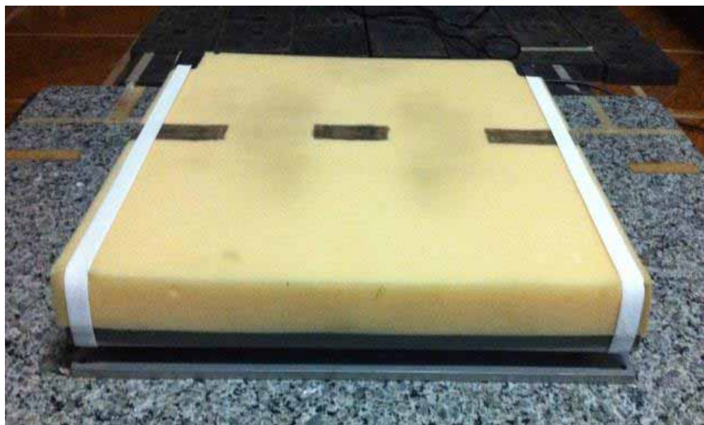
Figura 8: Espuma acoplada a plataforma de força com elásticos laterais
