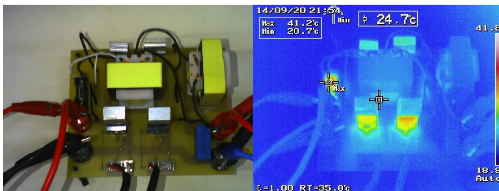
Figura 41 - Imagem infravermelha do conversor boost 3SSC-A operando com carga nominal.
