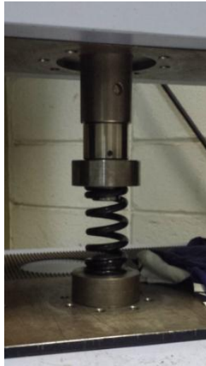
Figura 14 – Autograph AG-X após encaixe das bases e fixação da mola.
