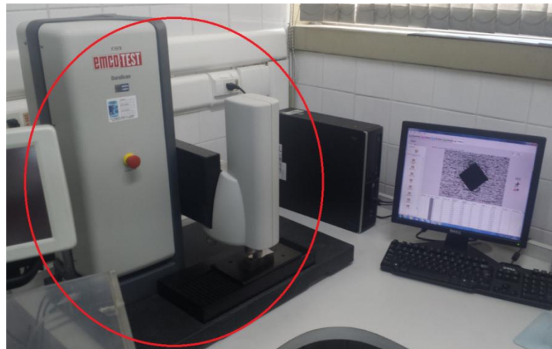
Figura 6 - Durômetro utilizado no ensaio de dureza Vickers de baixa força.
