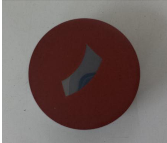
Figura 20 - Amostra da sessão longitudinal do arame da mola helicoidal de compressão.
