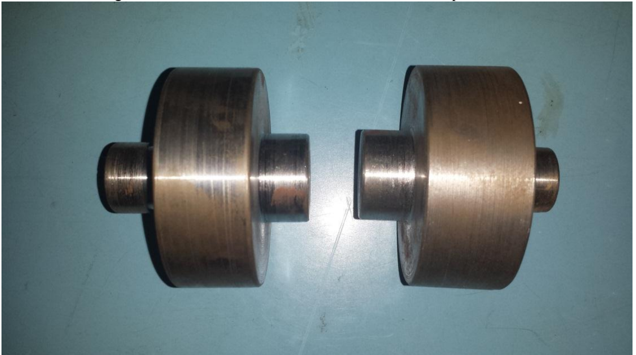
Figura 12 - Bases usinadas utilizadas no ensaio de compressão.
