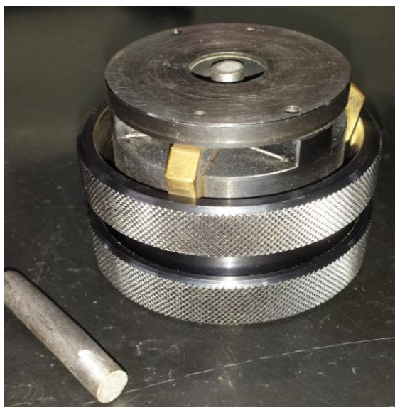
Figura 23 - Suporte da amostra utilizada no ensaio de espectrometria.
