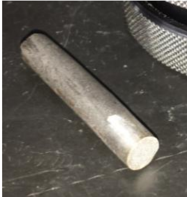
Figura 22 - Amostra utilizada no ensaio de espectrometria.
