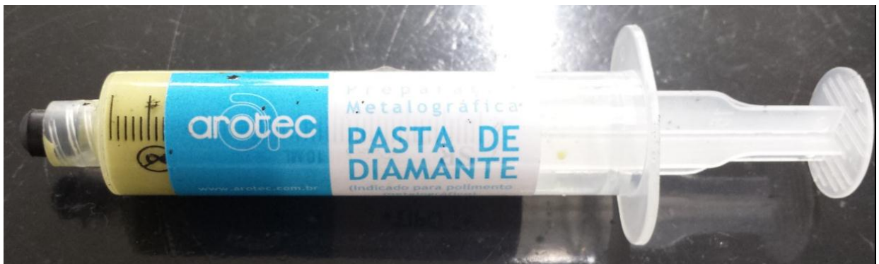
Figura 19 - Pasta de diamante de 3\mu para polimento da amostra a ser ensaiada.
