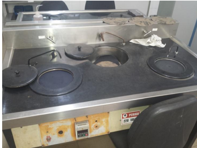
Figura 18 - Mesa de lixamento para preparação da amostra a ser ensaiada.
