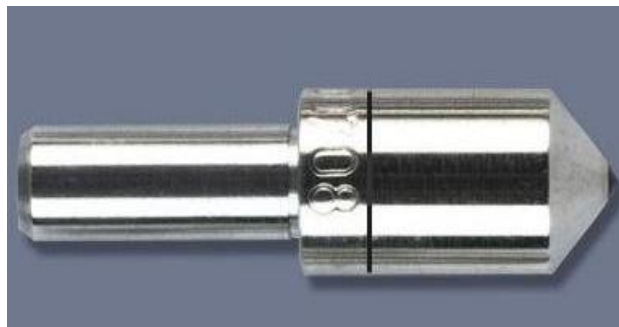
Figura 16 - Penetrador piramidal de base quadrada utilizado no ensaio.
