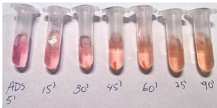
Figura 5.38: Alíquotas da solução da Rodamina-B retiradas ao longo do ensaio com FeB01P400
