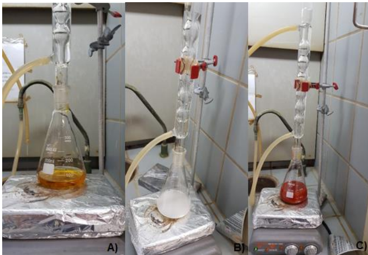
Figura 4.1: Sistema de refluxo contendo solução inicial para síntese: a) do \text{Fe}_2\text{O}_3 , b) do \text{SnO}_2 e c) do composto \text{Fe}_2\text{O}_3\text{-SnO}_2
