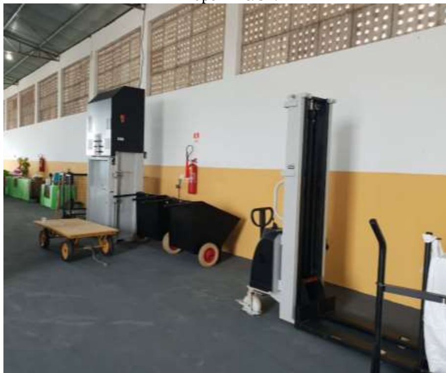
Figura 34 - Prensa Hidráulica Vertical, Carros de Movimentação de Rejeitos, Carrinho de Movimentação de Fardo e Elevador de Cargas Elétrico da “Cidade Joia – Cooperativa de Trabalho de Produção dos Catadores de Materiais Recicláveis de Pirapozinho”, em Pirapozinho/SP.
