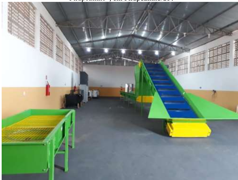
Figura 29 - Pátio de reciclagem e Esteira de Elevação de Resíduos da “Cidade Joia – Cooperativa de Trabalho de Produção dos Catadores de Materiais Recicláveis de Pirapozinho”, em Pirapozinho/SP.
