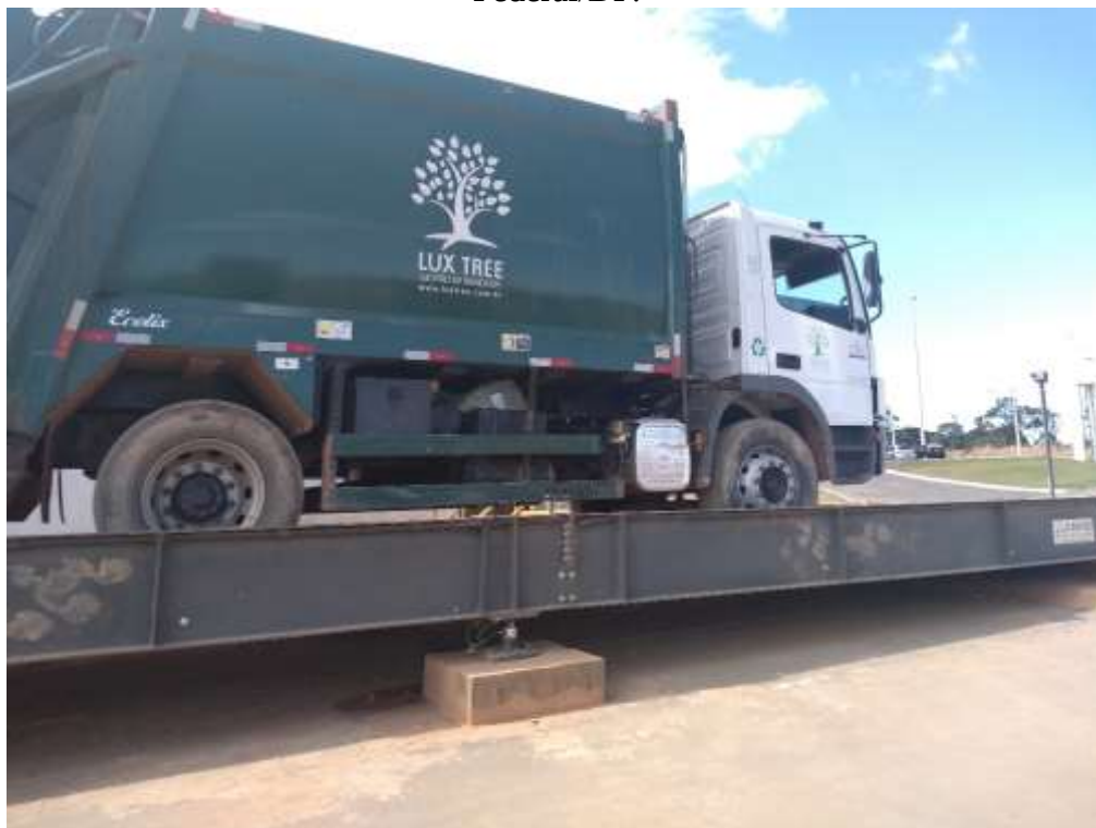
Figura 11 - Balança para pesagem dos caminhões no Aterro Sanitário de Brasília, no Distrito Federal/DF.
