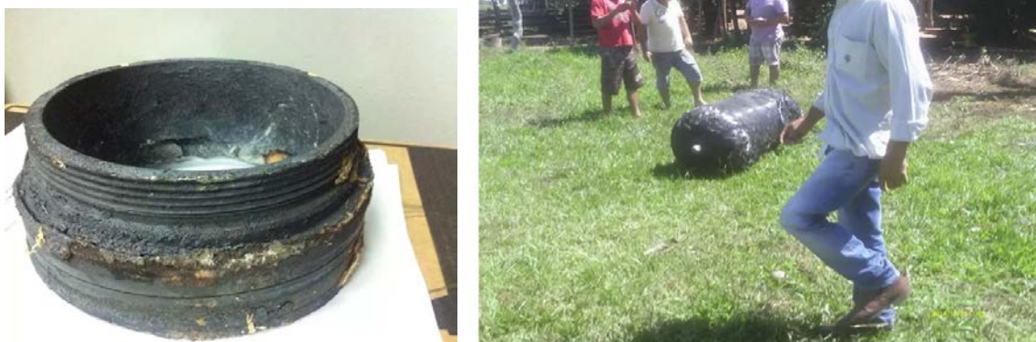
Figura 3.2: Detritos espaciais que caíram no Brasil: à esquerda um detrito espacial de 3 kg, a queda do objeto aconteceu no estado de São Paulo, à direita um tanque de nitrogênio que caiu em Mato Grosso do Sul. Estes objetos quase não foram danificados na sua reentrada e poderiam ser um risco enorme para áreas populosas. Fonte: http://g1.globo.com/ , 2014.
