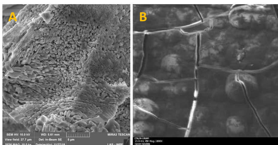
Figura 17 – Análise em MEV (10000x) da superfície da biopartícula \alpha -wollastonita
