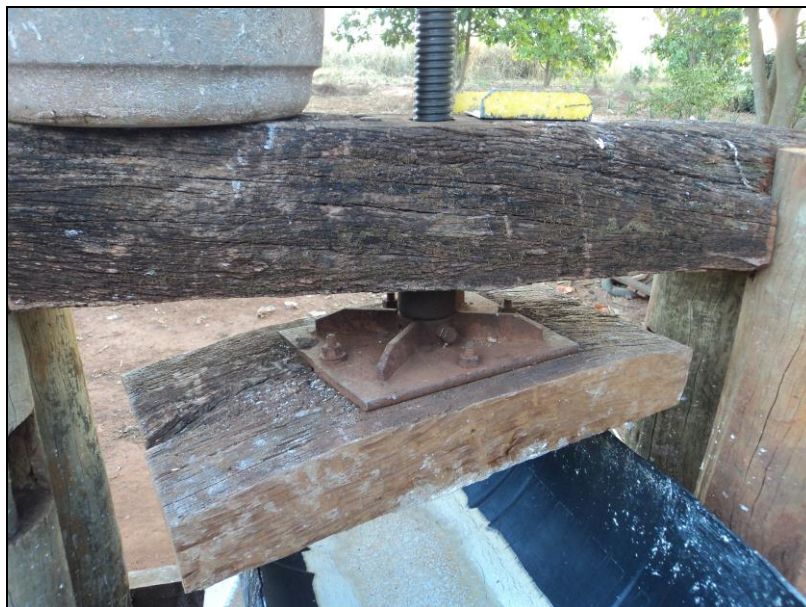
Figura 28. Prensa para retirada da água da mandioca para processamento de farinha. Assentamento Santa Maria da Lagoa. Município de Ilha Solteira/SP.
