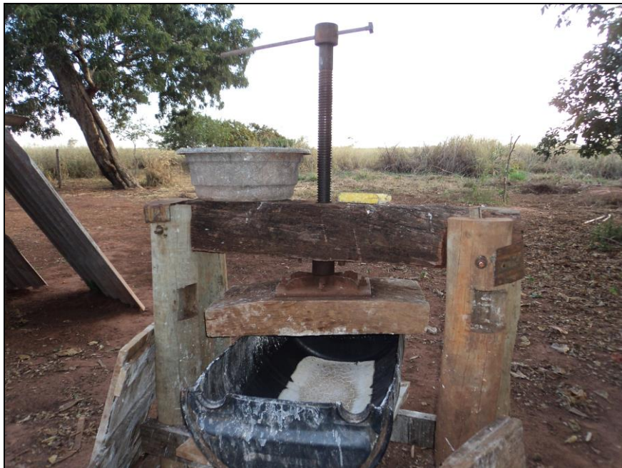
Figura 27. Prensa para retirada da água da mandioca. Assentamento Santa Maria da Lagoa. Município de Ilha Solteira/SP.
