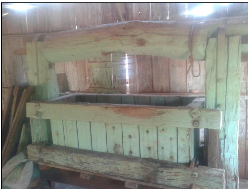
Figura 34. Prensa para retirada da água da mandioca para processamento da farinha. Assentamento Estrela da Ilha. Município de Ilha Solteira/SP.
