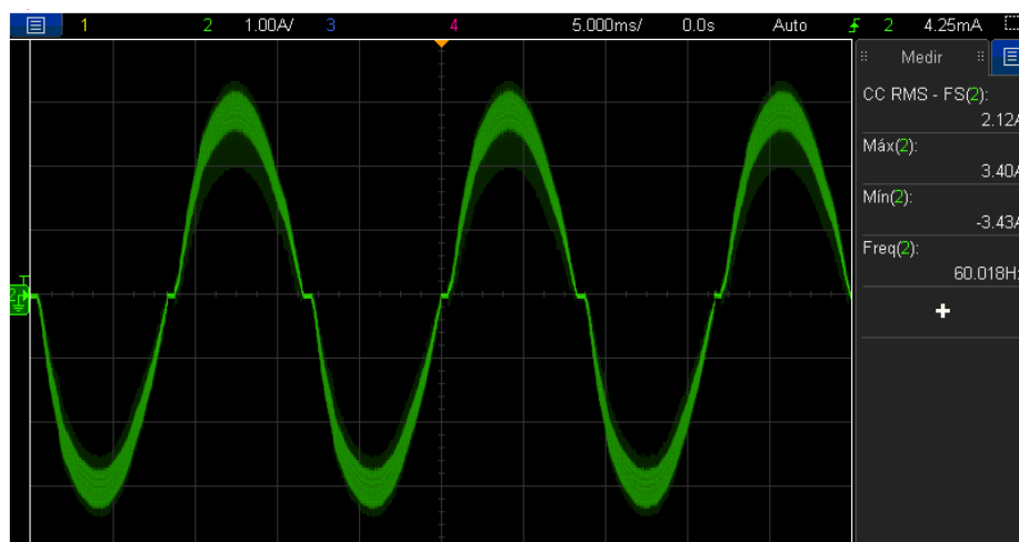
Figura 88 - Corrente na saída para um arranjo FV de 158,42W na entrada.
