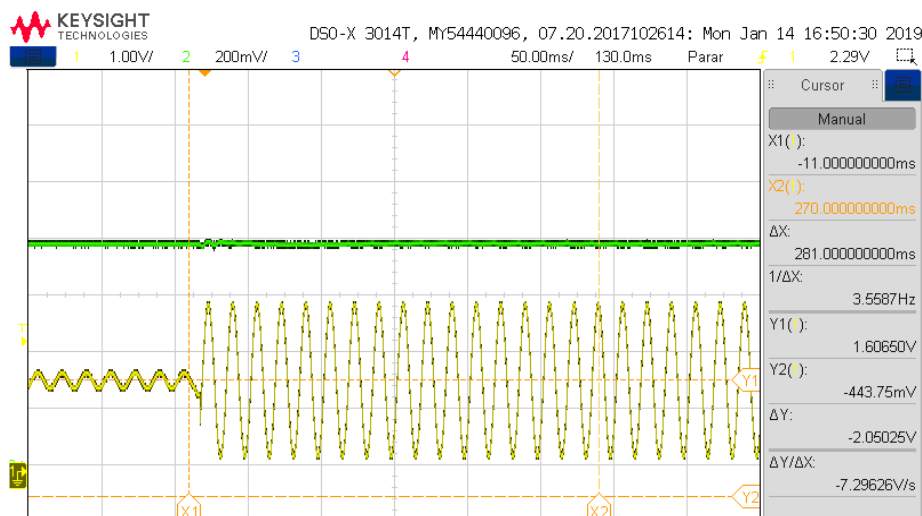
Figura 79 - Sinal de erro do EPLL (cor verde) e sinal do gerador (cor amarelo) diante de uma variação de amplitude de 0,9 p.u.
