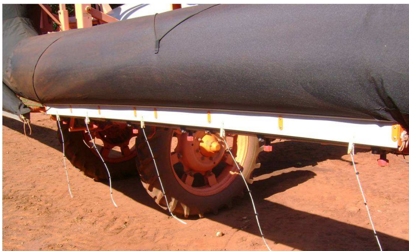
Figura 2. Detalhe da utilização do “método do fio” para medição da velocidade do ar.
