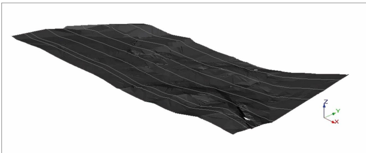
Figura 18 – Visão em perspectiva da localização das seções (linhas brancas) confeccionadas para a criação do modelo tridimensional do depósito. O eixo Y indica o Norte.
