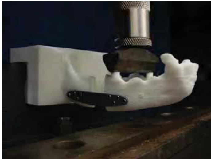
Figura 12 – Ensaio mecânico de flexão em mandíbula de cão da raça Boxer, com placa em ponte estabilizando defeito ósseo segmentar.
