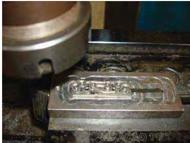
Figura 9 – Usinagem da placa em ponte, em titânio puro, na fresadora CNC.
