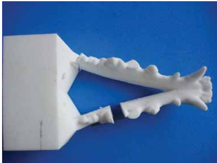
Figura 25 – Fratura da mandíbula esquerda de cão da raça Doberman após ensaio mecânico de flexão. Observar que o sistema placa-mandíbula não sofreu alteração.
