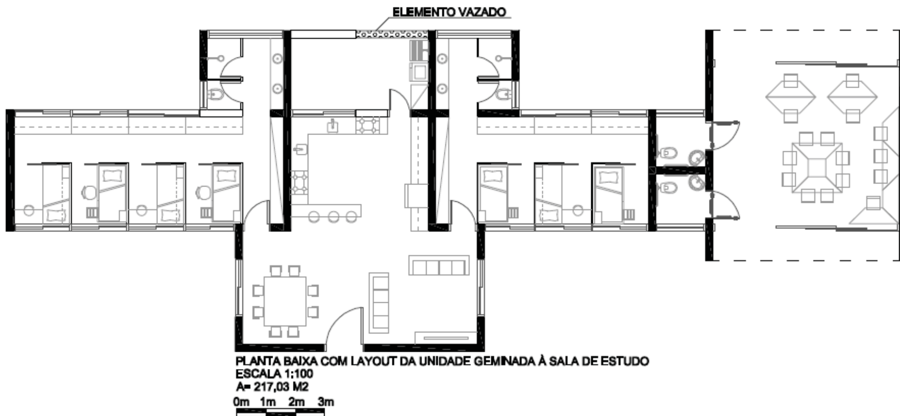
Figura 95: Planta baixa da unidade habitacional geminada à sala de estudo. Fonte: FERRO, 2011.
