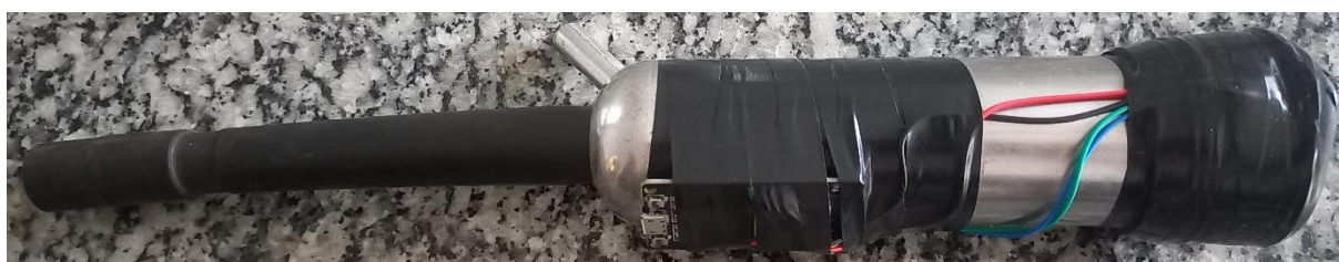
Figura 5- Dispositivo para identificação precoce de casos clínicos e subclínicos de mastite
