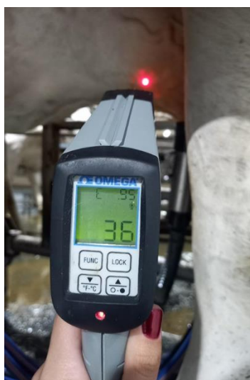
Figura 11 - Medição da temperatura superficial do úbere (TSU) com termômetro laser infravermelho OMEGA®
