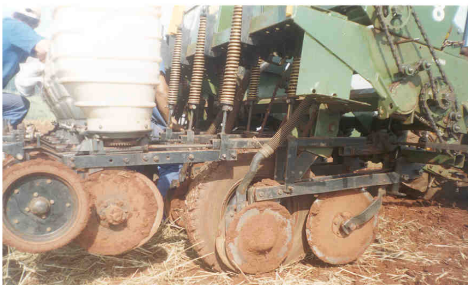
Figura 12 Disco duplo desencontrado utilizado na semeadora para deposição de fertilizante.
