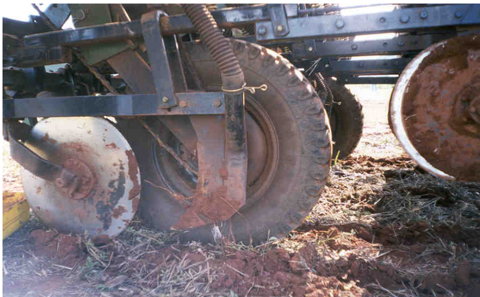
Figura 11 Haste sulcadora utilizada na semeadora para deposição de fertilizante.
