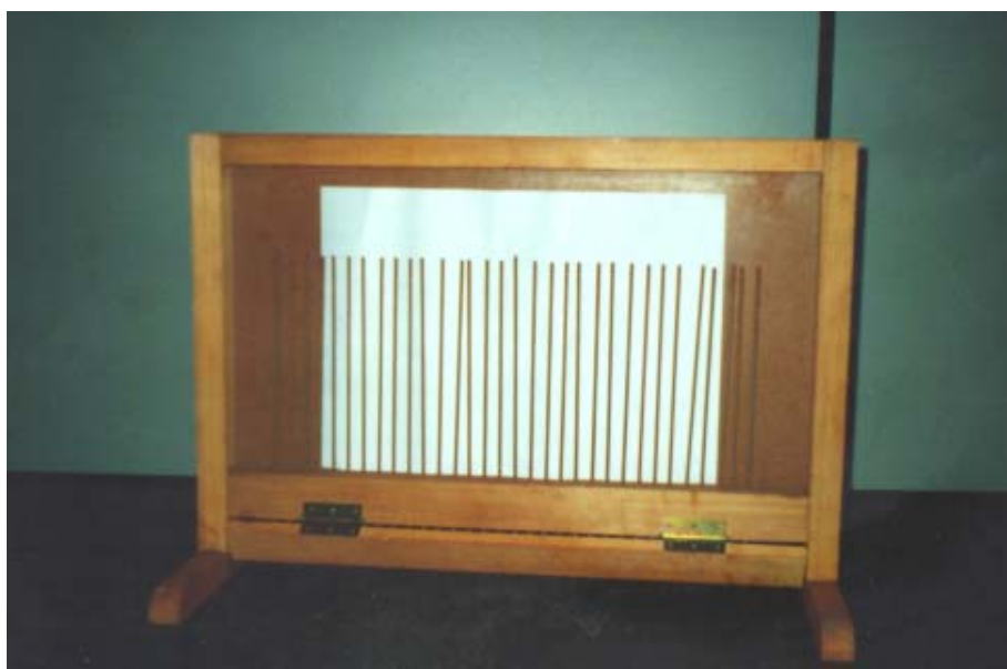
Figura 14 Mini perfilômetro utilizado para medir a profundidade de sulco de semeadura.
