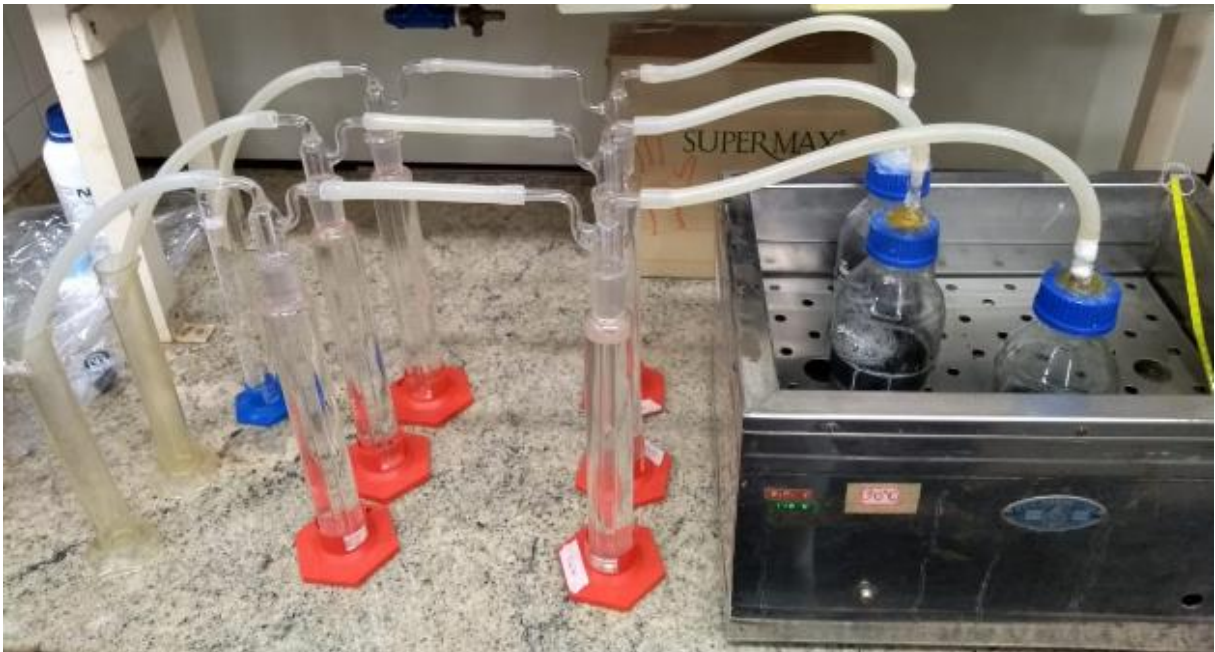
Figura 10 - Imagem dos sistema utilizado para captação de metano e determinação da atividade metanogênica específica.
