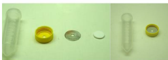
Figura 6. Dispositivo montado com tubos Falcon®, anel de alumínio com orifício central e septo de Teflon®.
